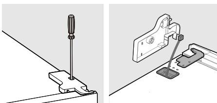
3. Retirez la charnière supérieure avec un clé à douille.
