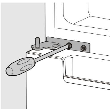
16. Connecter les bornes de l'interrupteur de porte au cache de charnière. Vissez le cache de charnière supérieure en place.
