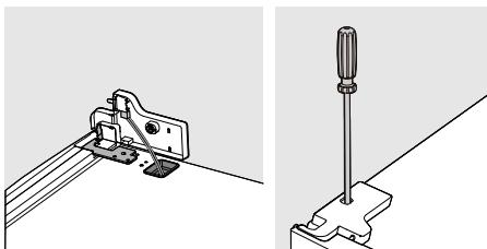
15. Replacez la porte supérieure. Placez la porte sur la charnière centrale et alignez-la avec l'unité en vous assurant que le joint d'étanchéité de la porte se ferme fermement avec l'unité. Fixez fermement la charnière supérieure à l'unité.
