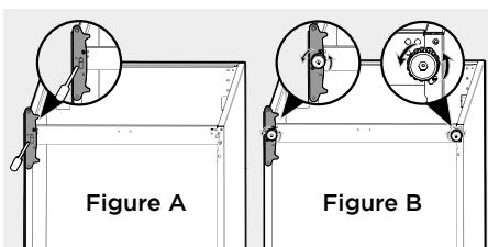
12. Retirez les fermetures d'aide inférieurs des portes supérieure et inférieure, puis retirez les nouvelles fermetures d'aide du sac d'accessoires et installez-les sur le côté gauche.
