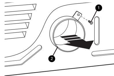
2 Introduzca a presión el conducto adaptador **3** en la carcasa del ventilador y fíjelo a la base de la secadora como se indica.
