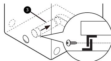
3 Inserte el codo **4** de 4 pulgadas (10.2 cm) a través de la abertura trasera e intodúzcalo a presión en el conducto adaptador. Asegúrese de que el extremo macho del codo apunte hacia abajo a través del orificio ubicado en la parte inferior de la secadora. Asegúrelo en su lugar con cinta adhesiva para conductos. Coloque la tapa **5** en la parte trasera de la secadora con el tornillo provisto.
