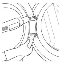
**3** Voltee la puerta y alinee los orificios de la bisagra con los orificios del gabinete. Vuelva a instalar la puerta con los tornillos que se quitaron en el paso 2.
