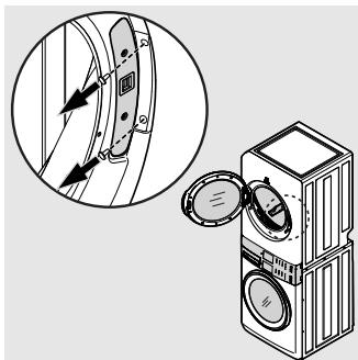
3. Retirez les deux vis du loquet de la porte. Conservez le loquet et les vis pour les réinstaller ultérieurement.
