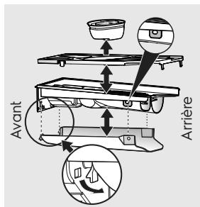
5. Rincez le tiroir du distributeur, les couvercles et le bouchon du détergent avec de l'eau chaude du robinet pour éliminer les traces des poudres et liquides accumulés. Une quantité importante de résidus d'assouplisseur peut être le signe d'une mauvaise dilution ou de la nécessité d'effectuer un nettoyage plus fréquent.
