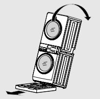
5. Inclinez l'appareil vers l'avant en position debout sur le plancher.
