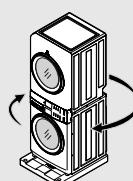
4. Tout en maintenant l'appareil en place en tout temps, inclinez-le vers l'arrière de manière à ce que la partie inférieure de l'arrière de l'appareil touche
