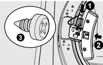
Réinstallez la vis à gros filetage
