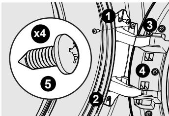
Réinstallez la vis à filetage fin
