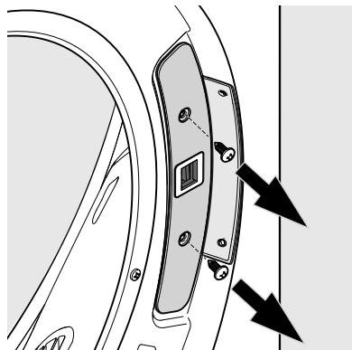
2. Retirez la vis qui maintient le couvercle à charnière. Conservez la vis et le couvercle pour la réinstallation.
