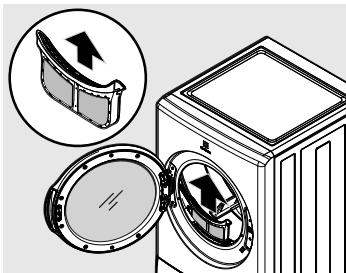
2. Appuyez sur le bouton situé sur le dessus du filtre pour ouvrir la double coque.
