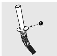
1. Disque anti-siphon Placez l'extrémité ainsi formée dans une cuve à lessive ou un tuyau vertical, puis fixez le tuyau de vidange à l'aide du serre-câbles (fourni dans le sac du manuel) au tuyau vertical, au tuyau d'admission, à la cuve à lessive, etc. afin que le tuyau ne soit pas éjecté par la force de l'eau.
