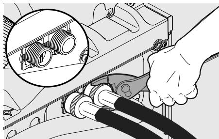
3. Connectez le tuyau d'arrivée CHAUD au raccord d'entrée CHAUD (rouge) et le tuyau d'arrivée FROID au raccord d'entrée FROID (bleu) sur le centre de lavage.
