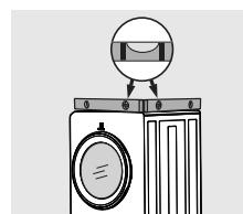
3. Appuyez sur les coins et les côtés les uns après les autres pour détecter le moindre mouvement. Réglez le(s) pied(s) concerné(s) de manière à ce que les QUATRE pieds de l'appareil reposent fermement au sol. Gardez les pieds de nivellement le plus bas possible de manière à optimiser les performances de l'ensemble laveuse/sécheuse.
