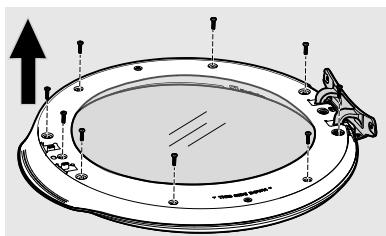
5. Soulevez l'anneau métallique et faites-le pivoter de 180 degrés, pour le réaligner sur le cadre intérieur. Assurez-vous que le joint n'est pas séparé de l'anneau métallique.
