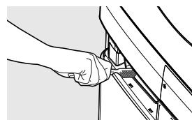
6. Replacez les éléments de fixation du tiroir en appuyant dessus jusqu'à entendre un léger déclic.
