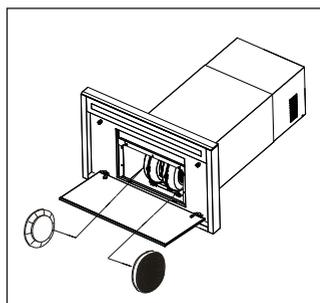
Réinstallez le filtre à graisse en fermant la plaque d'aspiration (fig. 21). Installez un filtre à charbon de chaque côté du moteur de la soufflante en insérant les filtres sur le goujon en forme de "T" et en les tournant pour les verrouiller en place.
