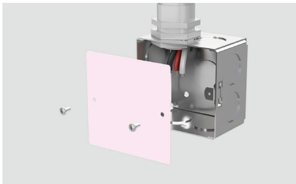
1. Desconecte la fuente de alimentación y retire la cubierta de la caja de conexiones.
