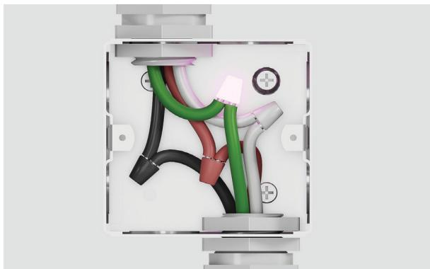
2. Conecte el cable de conexión a tierra verde del horno al cable de conexión a tierra (verde) de la caja de conexiones. No conecte el cable de conexión a tierra verde al cable neutro (blanco) en la caja de conexiones.
