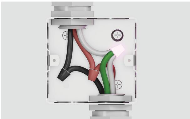
1. Conecte los cables del horno verde y blanco precintados de fábrica al cable neutro (blanco) en la caja de conexiones.
