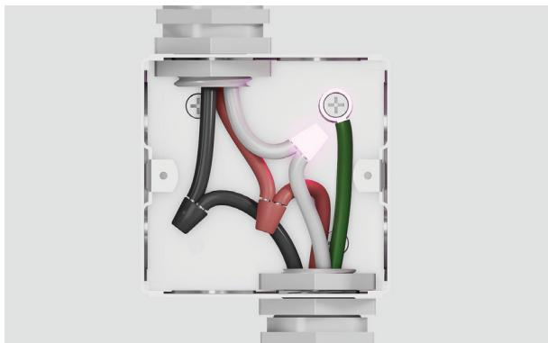
1. Separe los cables del horno verde y blanco precintados de fábrica. Si la caja de conexiones está conectada a tierra, conecte el cable verde a la caja de conexiones metálica con un tornillo antes de conectar el cable blanco del horno al cable neutro (blanco) de la caja de conexiones.
