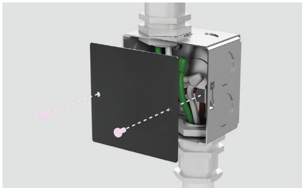
3. Vuelva a colocar la cubierta de la caja de conexiones.
