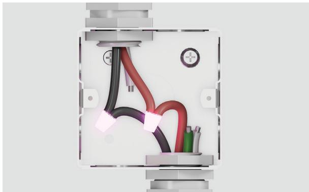
3. Conecte los dos cables negros juntos con los conectores de rosca y los dos cables rojos juntos con conectores de rosca.
