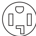
Tomacorriente de 4 hilos (14-30R)
