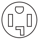
Tomacorriente de 4 hilos (14-30R)
