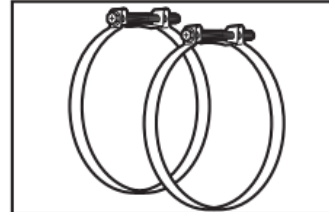
Brides de conduit
