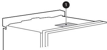
• No retire la cubierta de seguridad ①. Si lo hace, puede ocasionar incendios, descargas eléctricas o la muerte.
