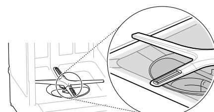
Tras extraer la bandeja inferior, coloque un nivel en la pared interior de la cuba para verificar que el lavavajillas esté nivelado lado a lado.
