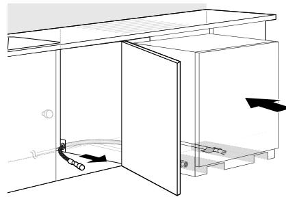
**3** Asegúrese de enderezar la manguera de desagüe antes de insertar su extremo a través del orificio para el suministro de agua. A medida que desliza el lavavajillas en la abertura, es conveniente que tire lentamente de la manguera de desagüe desde el interior del gabinete para enderezarla. Para evitar fugas o daños ocasionados por el agua, tenga cuidado de no plegar, aplastar o tensar demasiado la manguera de desagüe durante la instalación.
