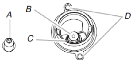
A. Électrode d'allumage B. Injecteur C. Porte-injecteur D. Vis
