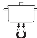
Para obtener los mejores resultados de cocción en la superficie, utilice solo utensilios de cocina de acero de alta calidad y de gran calibre en los elementos de cocción por inducción. Siga las recomendaciones del fabricante cuando utilice utensilios de cocina de inducción.
