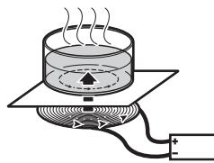
En lugar de calentar el vidrio cerámico, este método calienta la base de la sartén inmediatamente, lo que ahorra tiempo y energía. Dado que el calor requerido para cocinar se genera directamente en la base de la sartén, la zona de cocción en sí se calienta muy poco. La placa de cocción se calienta cuando se transfiere calor de los utensilios de cocina.
