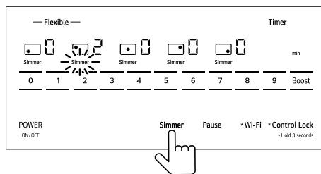
Por seguridad, luego de 6 minutos, el ajuste Boost volverá automáticamente al nivel de potencia 9.
