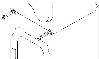
**3** Presione los tapones de los lados derecho e izquierdo del panel de control de la parte delantera del artefacto para abrirlos. Afloje los tornillos que se encuentran debajo de los tapones.
