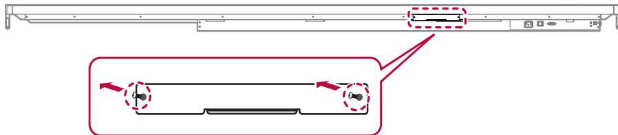
2 Siga la dirección de la flecha e inserte por completo el módulo de Wi-Fi en la ranura.
