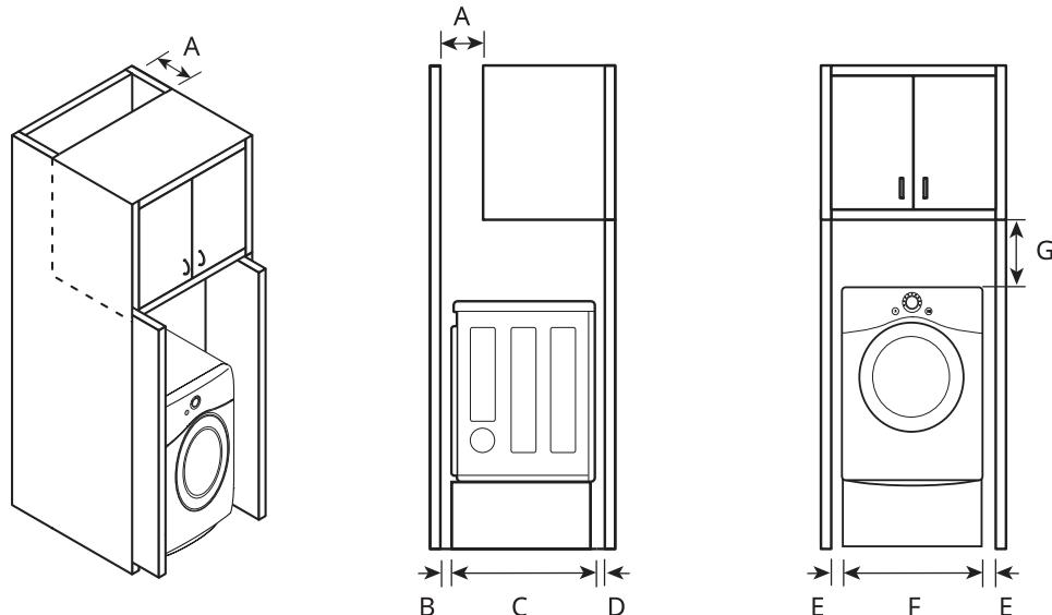
Para instalaciones en gabinetes con puerta, se requieren aberturas de ventilación mínimas en la parte superior del gabinete.
