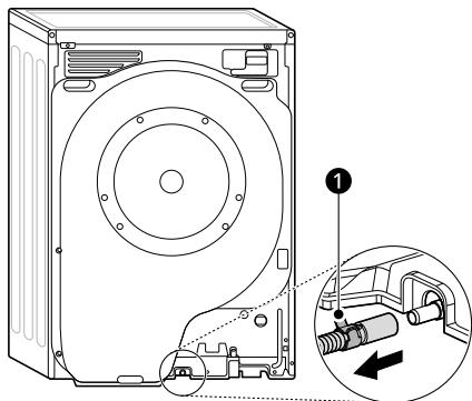
**2** Conecte la manguera de desagüe de la secadora y fije la abrazadera de desagüe.
