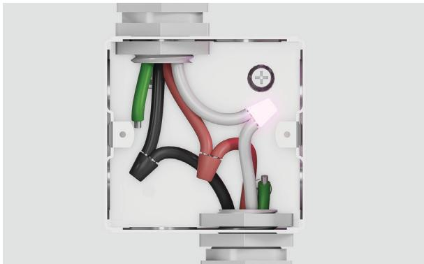
**5.** Separe los cables verde y blanco del horno. Conecte el cable blanco del horno al cable neutro (blanco) en la caja de conexiones.
