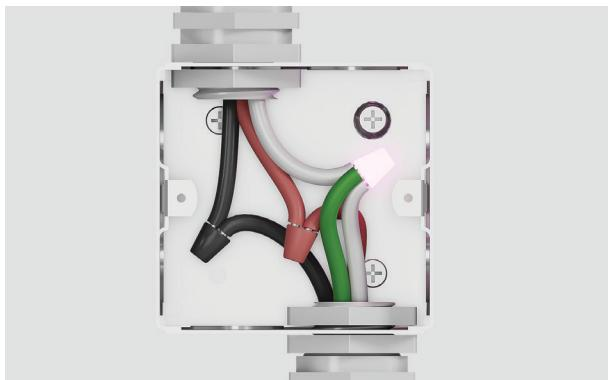
5. Conecte los cables del horno verde y blanco precintados de fábrica al cable neutro (blanco) en la caja de conexiones.
