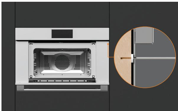
1. Use el producto para guiarse y perfore 2 orificios guía de 3 mm.
