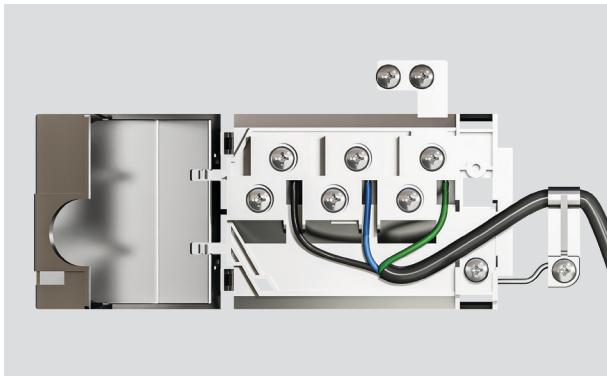
2. Realice la conexión al bloque de terminales como se muestra. Asegúrese de que el horno esté correctamente conectado a tierra y que la abrazadera del cable esté ajustada antes de cerrar la tapa.
