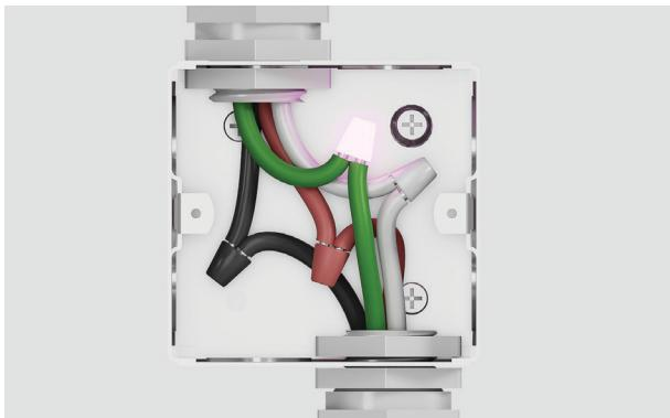
5. Conecte el cable de conexión a tierra verde del horno al cable de conexión a tierra (verde) de la caja de conexiones. No conecte el cable de conexión a tierra verde al cable neutro (blanco) en la caja de conexiones.
