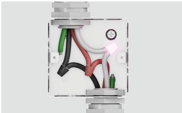
4. Separe los cables verde y blanco del horno. Conecte el cable blanco del horno al cable neutro (blanco) en la caja de conexiones.
