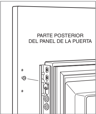
Montaje del panel de la puerta
