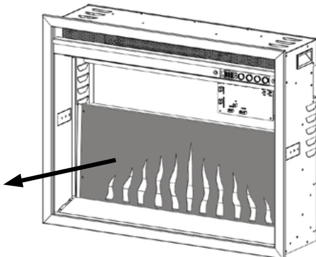
6. Disconnect the motor, then remove it. / Déconnectez le moteur, puis retirez-le.
