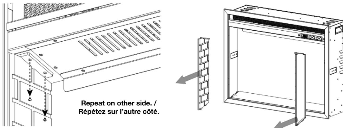
4. Remove the flame projection plastic panel. / Retirez le panneau en plastique de projection de flamme.
