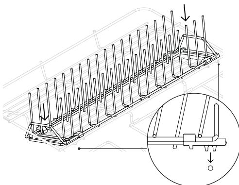
Alinez les clips avant et arrière avec la grille de la base et enclenchez la grille en place.
