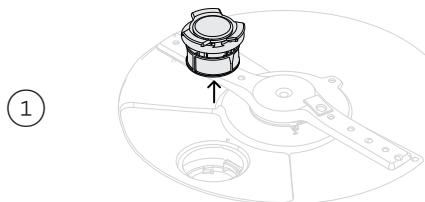
Faites pivoter le filtre de vidange dans le sens contraire des aiguilles d'une montre et soulevez-le pour le retirer.
