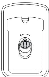
Tournez le bouchon dans le sens contraire des aiguilles d'une montre et retirez-le.
