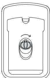
Réinstallez le bouchon, en tournant dans le sens des aiguilles d'une montre jusqu'à ce qu'il soit bien fixé.
