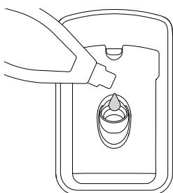
Versez le produit de rinçage dans l'ouverture, en veillant à ne pas en renverser dans le tiroir.
