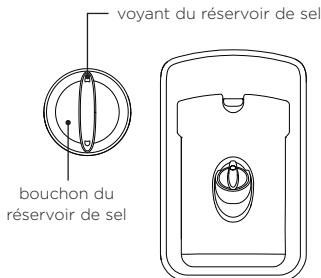
Le réservoir de sel est situé à l'intérieur du tiroir, près du distributeur de détergent. Il peut contenir environ 0,8 lb (350 g) de sel (la capacité réelle varie en fonction de la marque et la taille de grain du sel utilisé).
