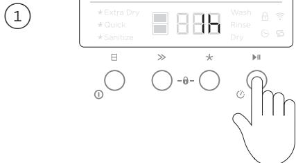
Maintenez la touche **▶▷** enfoncee jusqu'à ce que **lh** apparaisse sur l'afficheur pour accéder au mode **DELAY START (MISE EN MARCHE DIFFÉRÉE)**.
