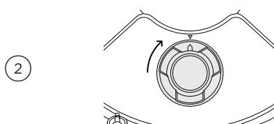
Poussez le filtre de vidange pour le remettre en place dans la cuve et tournez dans le sens des aiguilles d'une montre jusqu'à ce que les flèches sur le filtre et la base du tiroir soient alignées.
