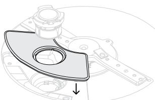
Poussez la plaque du filtre de vidange pour la remettre en place sur la cuve, en vous assurant qu'il n'y ait aucune particule dans la cavité.
