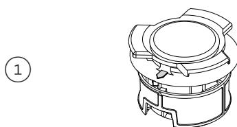
Réenclenchez la grille du filtre de vidange sur le support et faites pivoter jusqu'à ce que les flèches sur la grille et le support soient alignées.
