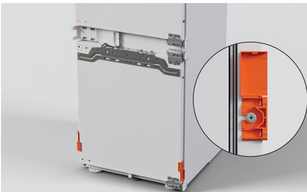
2. Instale dos soportes del panel de la puerta en la puerta del congelador.
