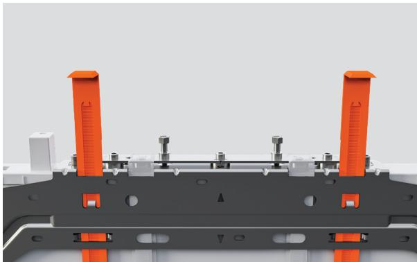
3. Levante el medidor de altura para quitarlo, gírelo de adelante hacia atrás y vuelva a insertarlo en la ranura adyacente. Ajuste el medidor hasta que haga clic en la posición correcta.
