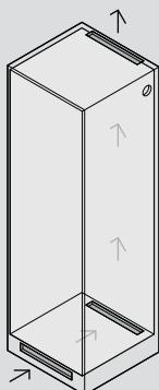
**2.** Asegúrese de que el hueco sea cuadrado, tenga un retorno terminado y cuente con un corte de ventilación a través del zócalo y hacia afuera de la cavidad. Evite ventilar directamente en los gabinetes adyacentes.
