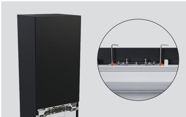
2. Ajuste la altura del panel con los tornillos del soporte colgante.
