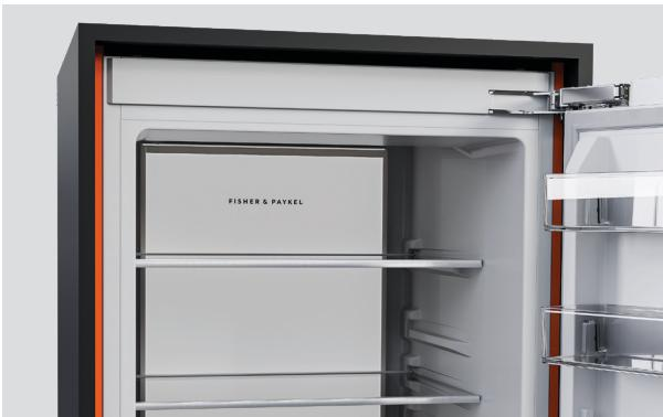
**6.** Instale las juntas del hueco. Corte cada junta a la medida con un corte plano, comenzando en la parte superior y recortando un poco más largo. Ajuste cada junta individualmente.
