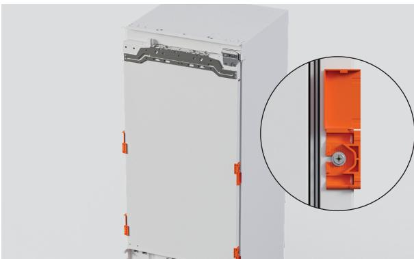
1. Afloje los tornillos y deslice los cuatro soportes del panel de la puerta sobre la puerta del refrigerador. Apriete para fijarlos.
