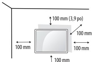
Assurez-vous d'utiliser les vis et les fixations murales qui répondent aux normes VESA. Les dimensions standard des trousseaux de fixation murale sont indiquées dans le tableau suivant.
