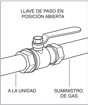
Llave de paso del suministro de gas
