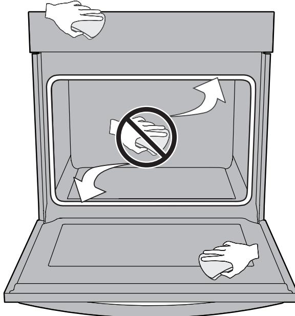
**Figura 7: Limpie alrededor de la junta de puerta del horno**
