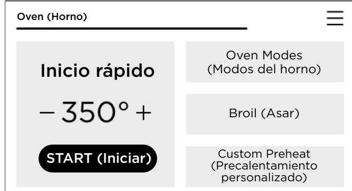
2. Toque **Oven Modes (Modos del horno)** y **Bake (Hornear)**. Aparecerá en la pantalla la temperatura predeterminada de 350 °F (176 °C). También puede utilizar los controles de la pantalla de Inicio rápido.
