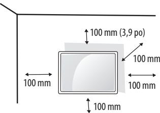
Assurez-vous d'utiliser les vis et les fixations murales qui répondent aux normes VESA. Les dimensions standard des trousseaux de fixation murale sont indiquées dans le tableau suivant.
