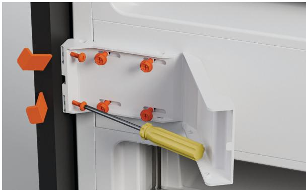
**6.** Fixez à travers la jauge de profondeur centrale. Enclenchez pour retirer toutes languettes de la jauge de profondeur et fermez le couvercle de la charnière centrale.
