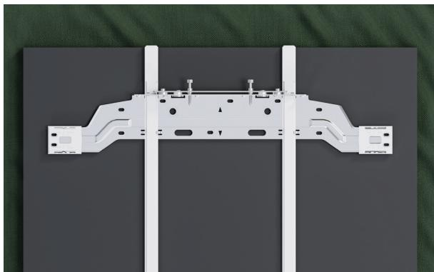
**7.** Placez le support à l'arrière du panneau avec les jauge de hauteur accrochées au bord supérieur.
