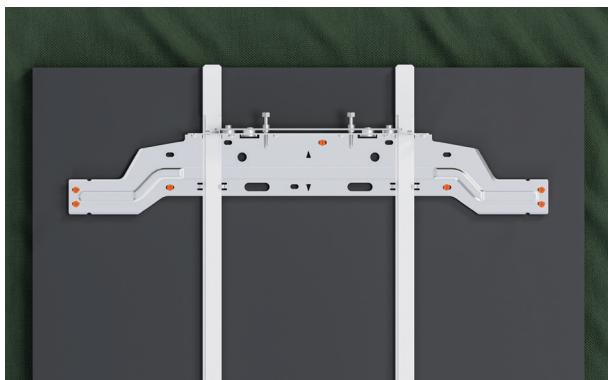
**9.** Fixez le support au panneau en utilisant les quatre petites vis des jauge latérales et les trois vis de la trousse d'installation. Percez des avant-trous avant de fixer les vis. Retirez les jauge, en laissant les guides d'alignement en place. Conservez les jauge pour les utiliser plus tard lors de l'installation du panneau.
