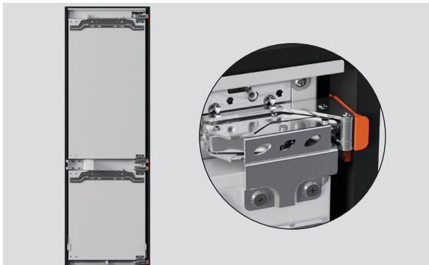
2. Alignez les supports latéraux des charnières de sorte que les entretoises reposent contre les parois de l'armoire et que les jauge de profondeur soient à niveau avec le devant de l'armoire.
