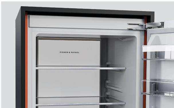
**6.** Installez les joints d'alcôve. Coupez chaque joint à la taille voulue avec une coupe droite, en commençant par le haut et en coupant légèrement plus long. Ajustez chaque joint individuellement.
