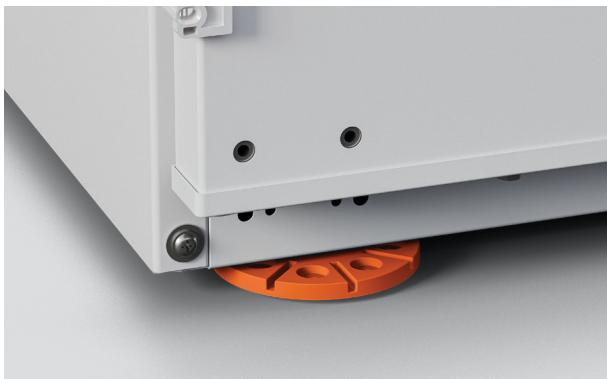
**4.** Ajustez les pieds à l'aide d'un tournevis à tête plate jusqu'à ce que toutes les jauge de profondeur soient à niveau avec l'armoire.
