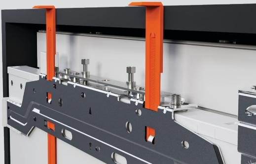
**4.** Élevez la jauge de hauteur jusqu'en haut de l'armoire. Alignez-la avec la base du panneau supérieur s'il y en a un, ou avec la base du panneau de porte s'il n'y a pas de panneau supérieur.
