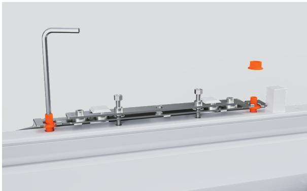
**2.** Retirez les écrous, puis soulevez les bras de suspension du panneau de porte de  $3/16$  po (5 mm) à l'aide d'une clé Allen.
