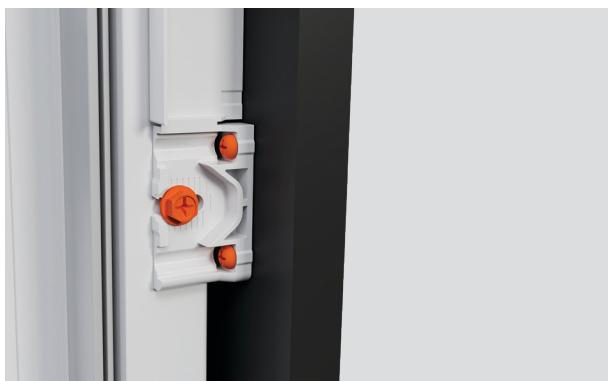
**4.** Vissez les supports du panneau à la porte. Ajustez vers l'intérieur ou vers l'extérieur pour régler l'espacement, en prenant soin de ne pas trop serrer.
