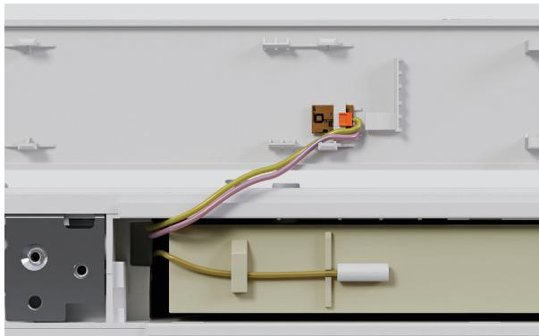
**5.** Retirez le capteur en veillant à ne pas l'endommager.
