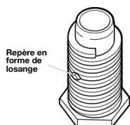
Pied de nivellement avec repère en forme de losange
