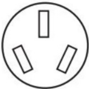
Tomacorriente de 3 hilos (10-50R)
