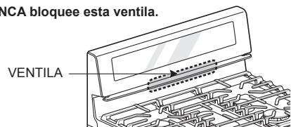
**No cubra la superficie de la placa de cocción con papel de aluminio. Bloquear la ventila del horno puede dañar el panel de control.**
