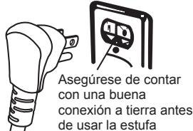
No utilice un enchufe adaptador. Desconectar el cable de alimentación genera tensión indebida en el adaptador y genera una falla eventual en la terminal a tierra del adaptador.
