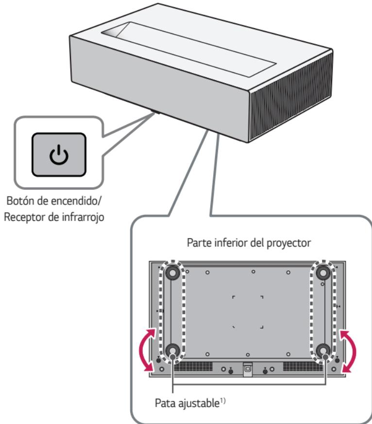
1) Gire la pata ajustable hacia la izquierda o la derecha para ajustar el ángulo.
