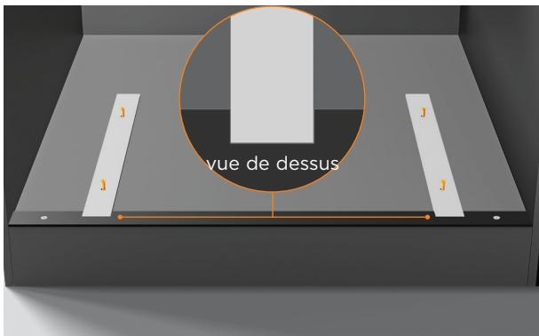
2. Placez les deux pièce d'espacement latérales en place. Assurez-vous que les pièces d'espacement sont uniformément espacées à l'avant et à l'arrière de la cavité. Fixez-le à l'aide des deux vis Phillips fournies de chaque côté.
