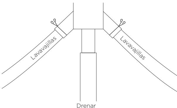
2. Enrosque los sujetacables en las mangueras antes de montar ambas mangueras en el kit de doble espacio de aire.
