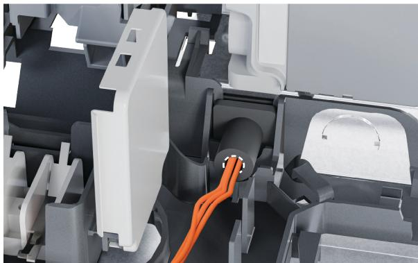
**6.** Corte con seguridad el cable desde el interior **y el exterior** de la moldura de alivio de tensión para retirarlo.
