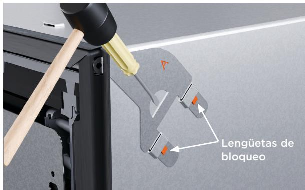
2. Si utiliza el conjunto de soportes superiores, insértelos en las ranuras y golpee suavemente con un mazo blando para asegurar.
