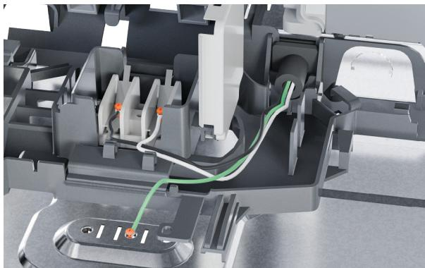
**5.** Desatornille los cables de fase (negro), neutro (blanco) y tierra (verde) del bloque de terminales y de la carcasa.
