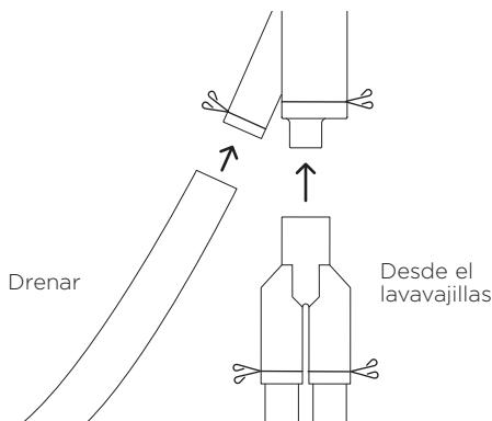
2. Enrosque los sujetacables en las mangueras antes de conectar ambas mangueras al conector de mangueras suministrado.
