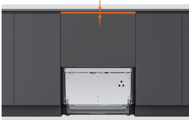
1. Coloque el panel superior sobre el soporte de la puerta. Mida la distancia entre la parte superior del panel del cajón y la encimera o el marco para el ajuste de altura.
