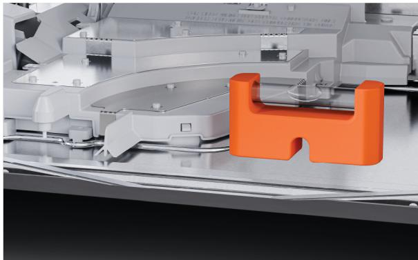
**6.** Coloque un nivel en el área plana de la carcasa para verificar que el lavavajillas esté nivelado de atrás hacia adelante y de izquierda a derecha.
