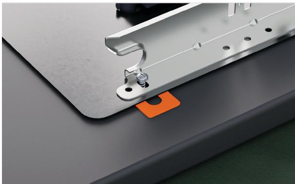
**3.** Inserte la cuña entre el panel y el soporte de la puerta y apriete el tornillo.
