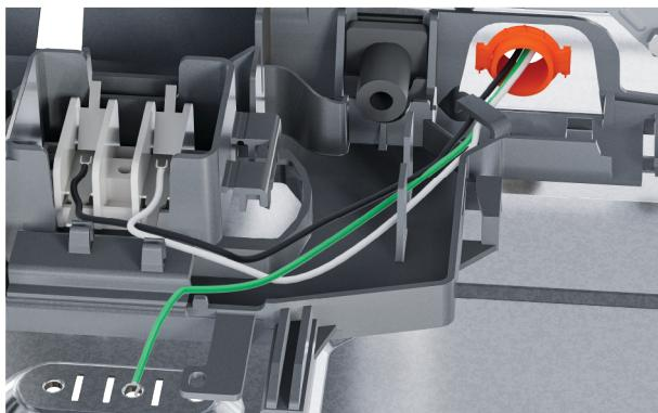
**7.** Instale una abrazadera de cable adecuada para el conducto a través del orificio metálico.
