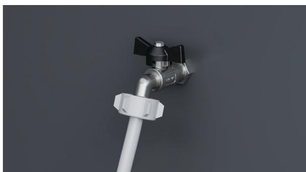
3. Ajuste a mano en su lugar. Usando una llave inglesa o unos alicates, gire 180° adicionales para fijar. Evite apretar en exceso.
