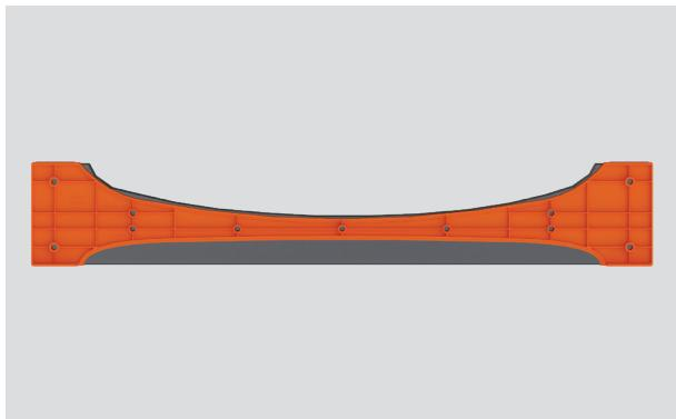
Para una profundidad de zócalo de 3 15/32 a 3 15/16", la curva más ancha (perfil B) se cortará del zócalo.
