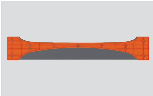
Para una profundidad de zócalo de 1 9/16 a 3 15/32", se cortará la curva poco profunda (perfil A) del zócalo.
