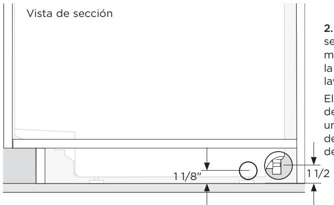
**2.** El centro del orificio de servicio debe estar a un máximo de 1 1/2" del piso o de la parte inferior de las patas del lavavajillas.
