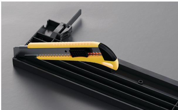
3. Marque el zócalo en ambos lados con un cíter sobre una superficie protectora.
