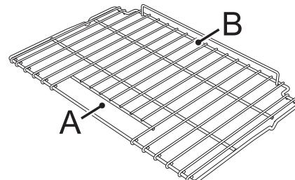
La grille est équipée de dispositifs de blocage mécaniques qui l'empêchent d'être retirée accidentellement :
