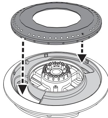
3. Le couvercle du brûleur doit être nivelé et centré par rapport au dosseret du brûleur.
