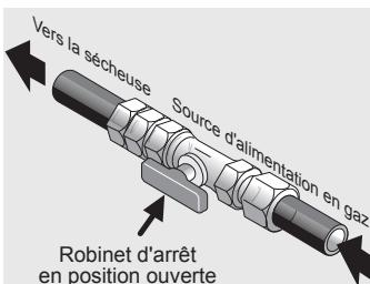
4. Vérifiez la présence de fuites du système de gaz à l'aide d'un manomètre. Si aucun manomètre n'est disponible, testez tous les raccords en brossant avec une solution d'eau savonneuse.
