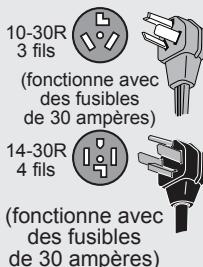
Un cordon d'alimentation certifié UL doit être installé sur les sécheuses électriques (non inclus, sauf pour les modèles fabriqués pour être vendus au Canada).
