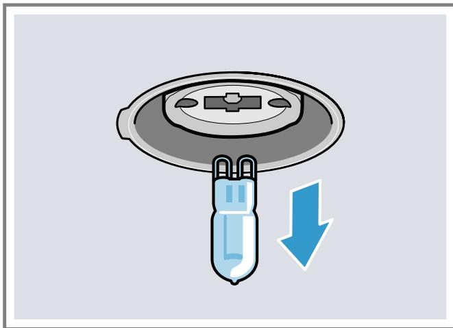
5. Ne touchez pas directement le verre de la nouvelle ampoule de recharge, car l'huile de vos doigts peut provoquer une défaillance prémature de l'ampoule. Saisissez plutôt l'ampoule de recharge avec un chiffon sec et propre. Repérez les deux tiges dans le support de céramique, en tâtant légèrement jusqu'à ce que les deux tiges s'insèrent dans la douille céramique.
