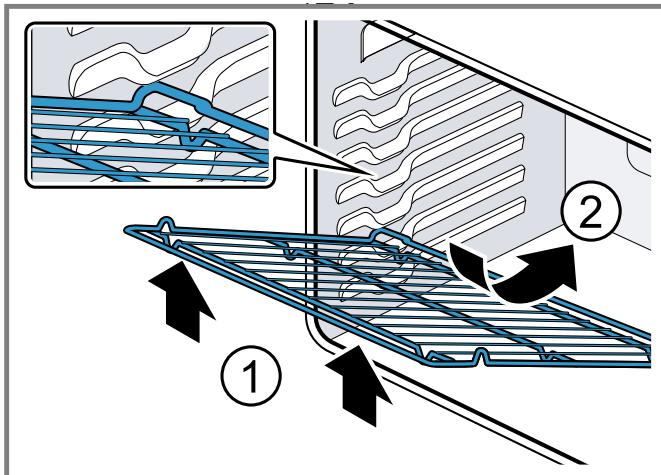
La grille doit être droite et plate, pas tordue.
