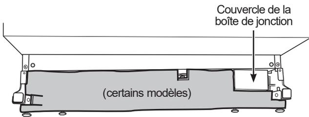
Le matériau illustrée correctement placée le long au bord inférieur de la boîte de commande, le de la partie inférieure du lave-vaisselle et affleurant la face avant.
