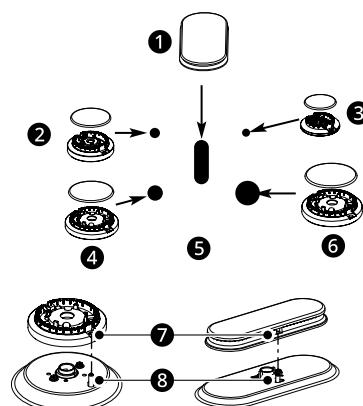
① Juego de cabezal/tapa del quemador ovalado (central)
