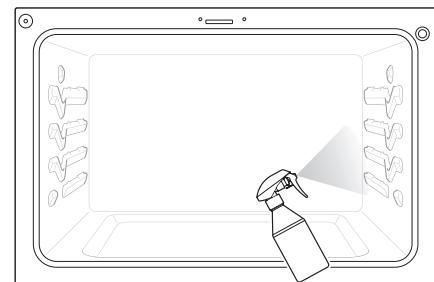
**5** Rocíe o vierta el agua restante (8 oz o 240 ml) en el centro de la base de la cavidad del horno. La hendidura en la base del horno debe estar totalmente cubierta para sumergir toda la suciedad. Agregue agua si fuera necesario.
