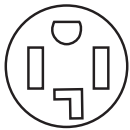
Tomacorriente de 4 hilos (14-30R)
