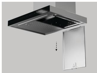
Jale el cerrojo e incline el filtro hacia abajo hasta que esté en posición vertical y a continuación, levante el filtro para desengancharlo de los soportes.
