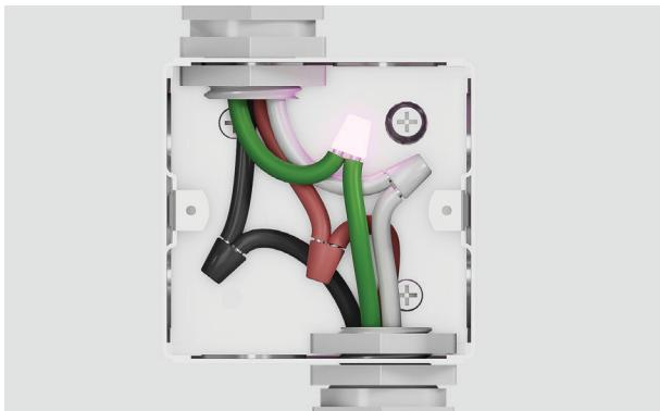
**6.** Connectez le câble de mise à la terre vert au fil de mise à la terre (vert) dans la boîte de jonction. Ne connectez pas le fil de mise à la terre vert au fil neutre (blanc) dans la boîte de jonction.
