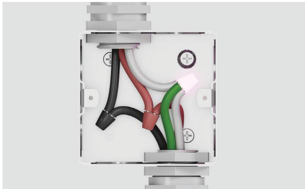
5. Connectez les fils vert et blanc du four, fixés en usine, au fil neutre (blanc) de la boîte de jonction.
