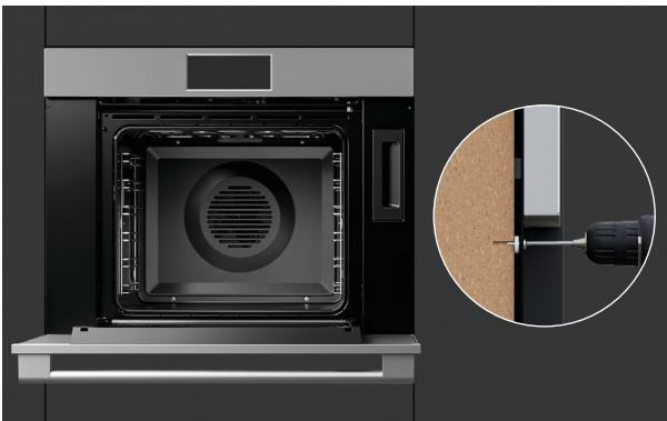
**3.** Sécurisez le four à la cavité à l'aide des 2 vis à tête cylindrique #8x22 fournies.
