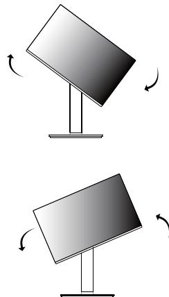
4 Para completar la instalación, gire el monitor 90° como se muestra a continuación.
